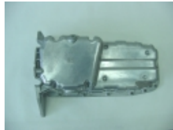
Figura 76 – Cárter de alumínio Fonte: Motor Stilo - FIAT
