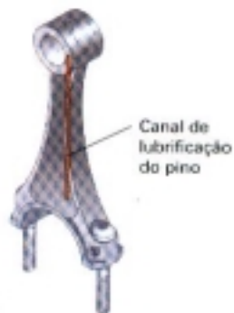
Figura 55 – Canal interno da biela
