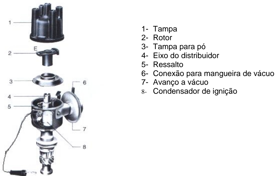
Figura 162 - Componentes do distribuidor
