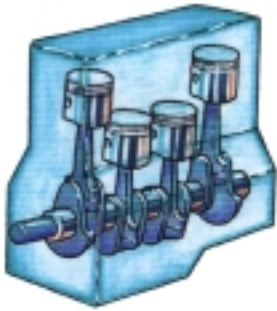
Figura 60 – Árvore de manivelas de motor em linha
