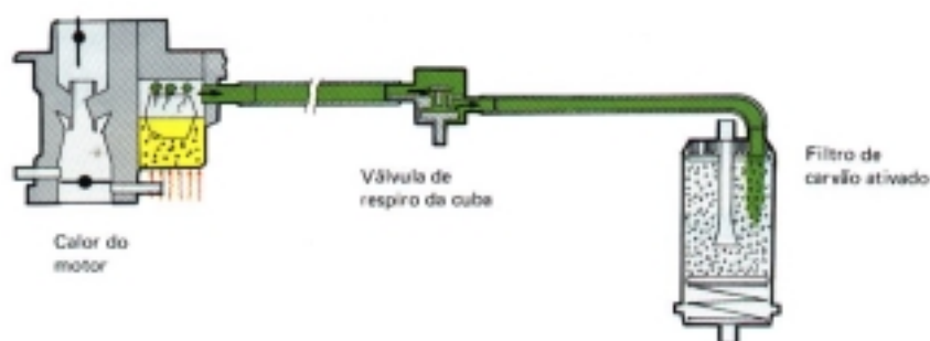
Figura 142 - Vapores do carburador sendo direcionados ao filtro de carvão ativado
